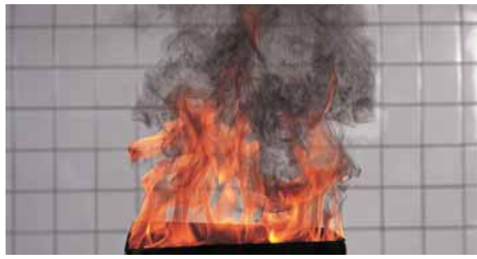
Test yangını 5: sıvı yangını (n-heptane)
