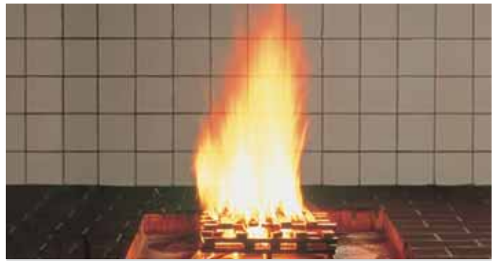
Test yangını 1: açık selüloz yangını (ahşap)
